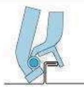
Das Schließen vom Winkelkant zum Doppelfalz ist in einem Arbeitsgang durchführbar.
