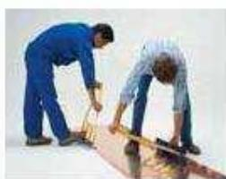
Die Anschläge lassen sich mit zwei Handgriffen vom hohen zum niedrigen Falz umstellen und umgekehrt. Die Auflauhöhe ist in 5 mm-Schritten einstellbar, von 20 mm bis 60 mm.
