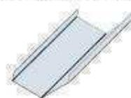
Kehle aus einem Stück von Bandblech gebogen. Es ist überall dicht, da es keine Naht aufweist.
